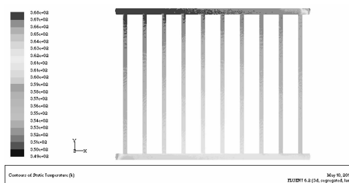
图5 传统钢铝复合柱翼型散热器管内热水温度分布云图
