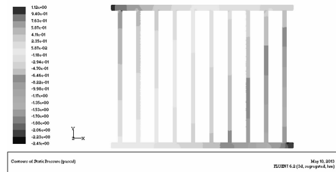
图9 传统钢铝复合柱翼型散热器管内压力分布云图
