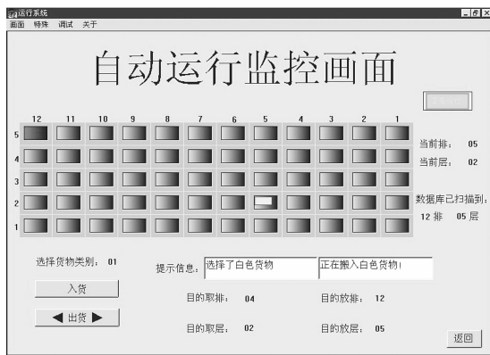
图 4 堆垛机控制系统监控界面
